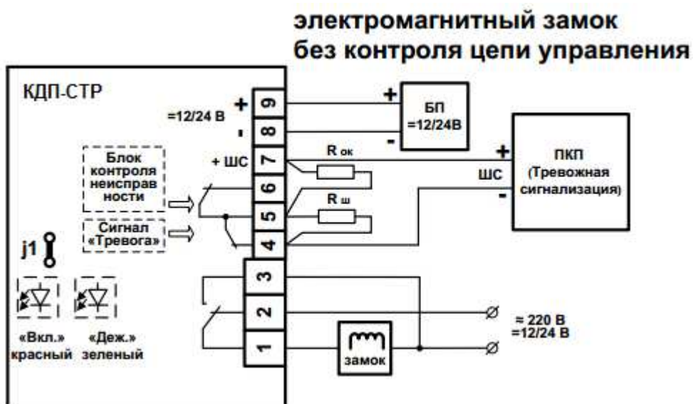
Рис.9. Подключение извещателя к электромагнитному замку без контроля цепи управления.
